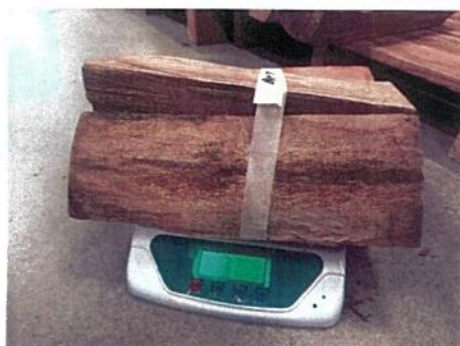
Rys. 4.3. Ważenie porcji drewna przygotowanej do testu spalania.
